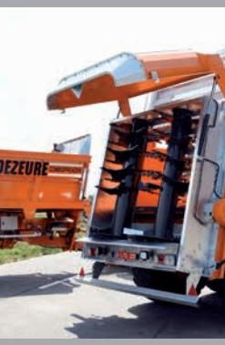
**DISCUS:** 2 horizontale freewalsen (Ø 650mm) en een strooitafel met 2 grote galvaniseerde strooischijven (Ø 1000mm) met 4 verstelbare schoepen. De walsen worden afgedekt met een regelbare hydraulische kap. Deze strooi-unit wordt gekozen om verschillende producten (stalmest, compost, restmateriaal, kalk, kippenmest, enz.) op grote breedte te strooien (tot 30m). De DISCUS heeft een uiterst precieze verspreiding van de producten, zelfs bij een kleine dosering.
